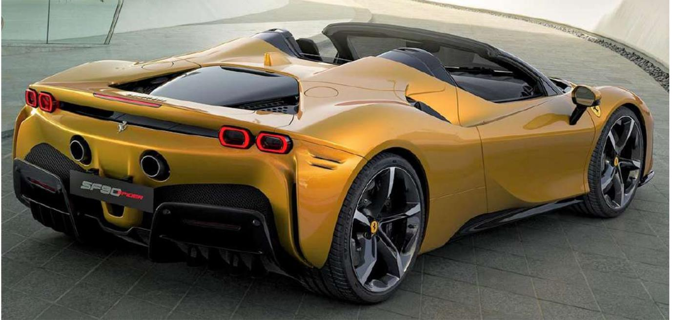
Versión descapotable del superdeportivo híbrido enchufable SF90 equipado con el motor V8 y sistema híbrido, compuesto por tres motores eléctricos adicionales, que le confieren 1.000 caballos de potencia.
